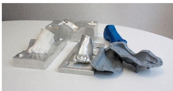
3D-Scandaten führen zu gefrästen und gedruckten Fußmodellen
